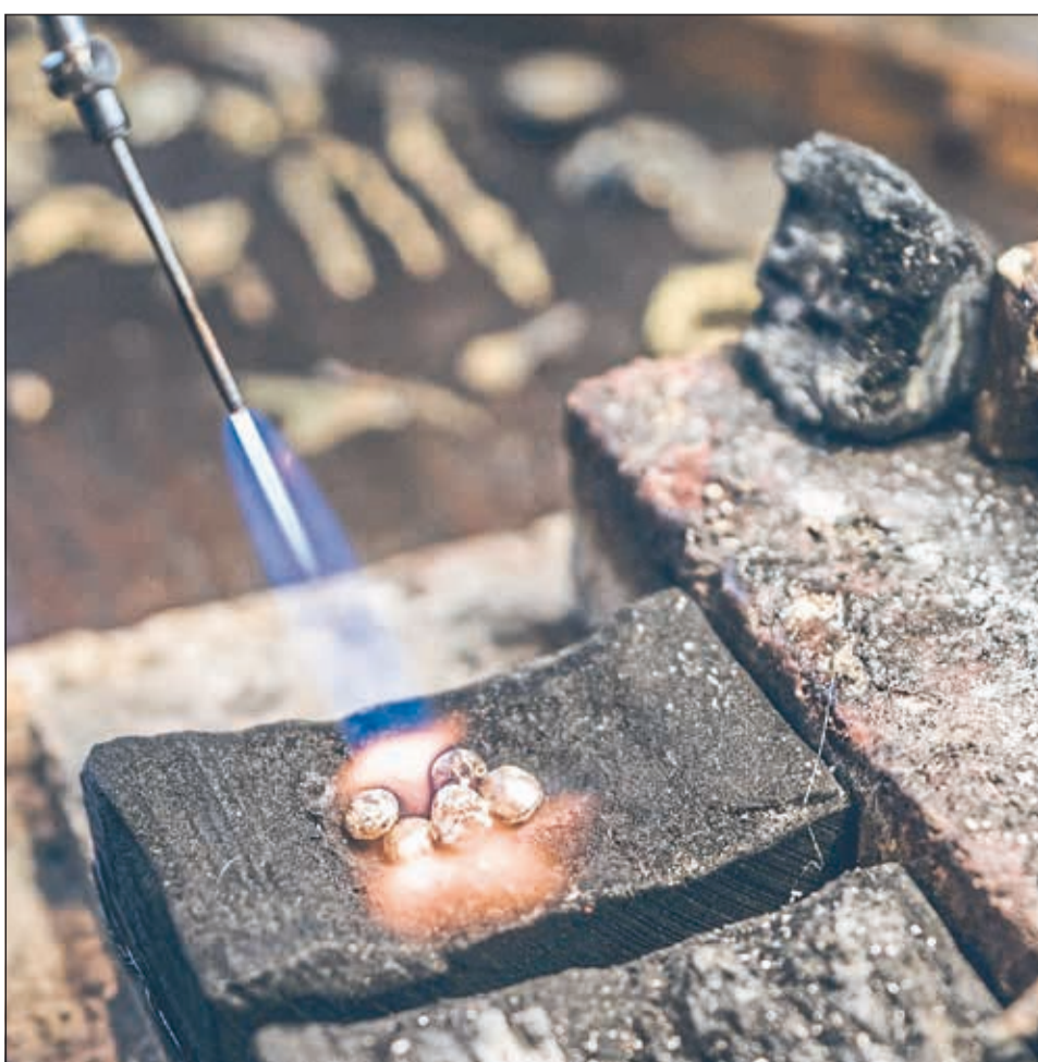
Mit dem Brenner kann Isabella Zwick das Gold einschmelzen. Sie nimmt ein paar winzige Goldnuggets und legt sie auf ein Stück Holzkohle. Dieses leitet die Hitze, hält ihr Stand.
