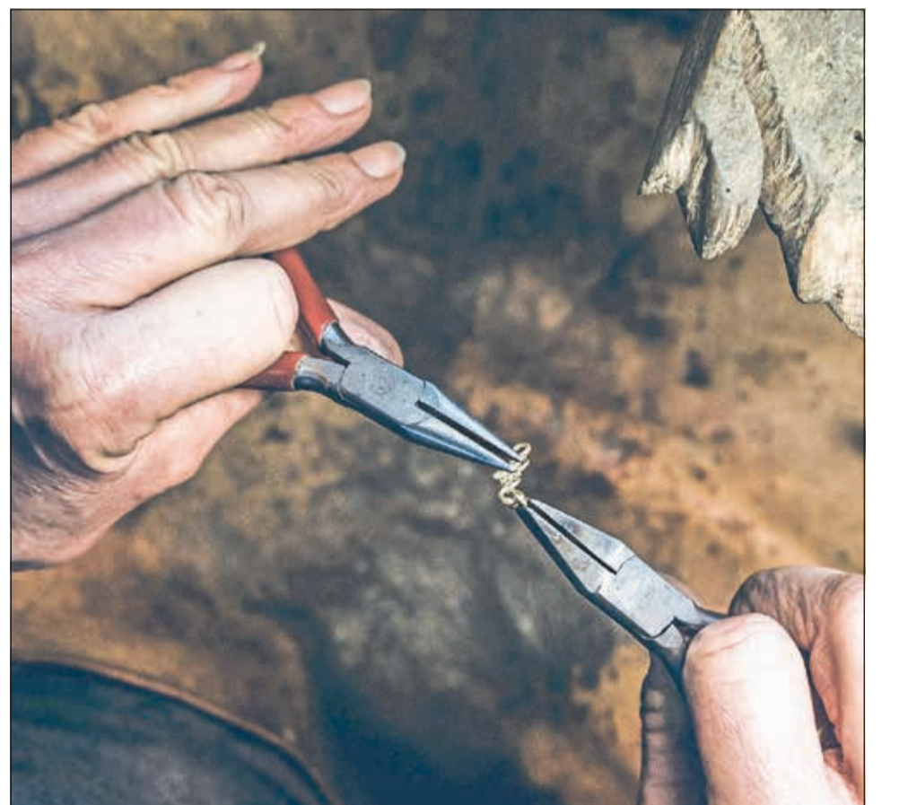
Die einzelnen Ösen nimmt Isabella Zwick nach dem Sägen, um die Glieder zu einer filigranen Goldkette zu verbinden.
