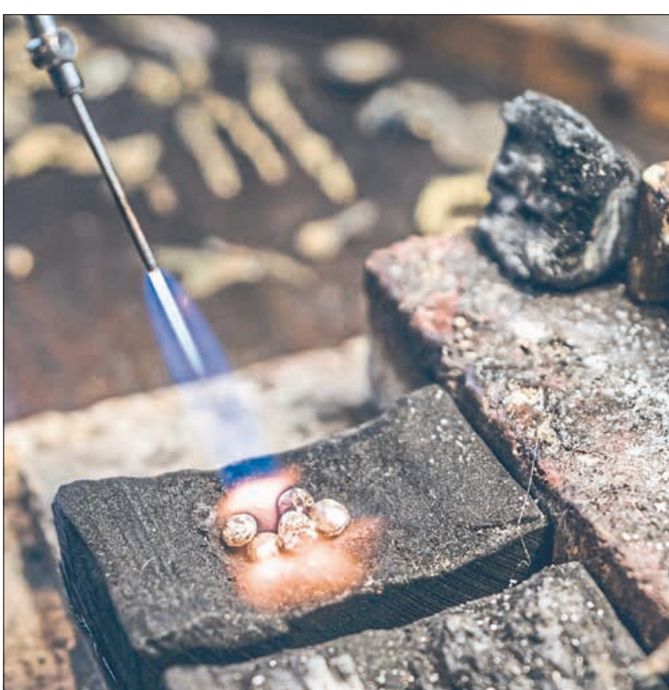
Mit dem Brenner kann Isabella Zwick das Gold einschmelzen. Sie nimmt ein paar winzige Goldnuggets und legt sie auf ein Stück Holzkohle. Dieses leitet die Hitze, hält ihr Stand.
